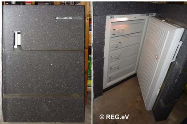
Außen isolierter Gefrierschrank mit geschlossener und offener Tür (5 Schubladen innen)
